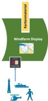
Das WIS-Produkt WINDFARM DISPLAY stellt ein situationsabhängiges Lagebild des Arbeits- und Einsatzbereiches eines Offshore-Windparks dar. Das WINDFARM DISPLAY dient der Verhütung von Unfällen und der frühzeitigen Erkennung von Schiffskollisionen (Nautische Seeraumbeobachtung). Es ist möglich, zum Beispiel AIS- und/oder Radar-Daten darzustellen. Der Anschluss weiterer Sensorik, wie z. B. CCTV oder Vogelflugradar, ist jederzeit möglich.
